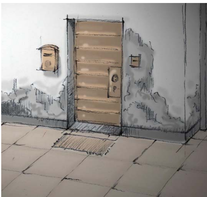
fig. 6: Degrado da acque meteoriche o umidità
