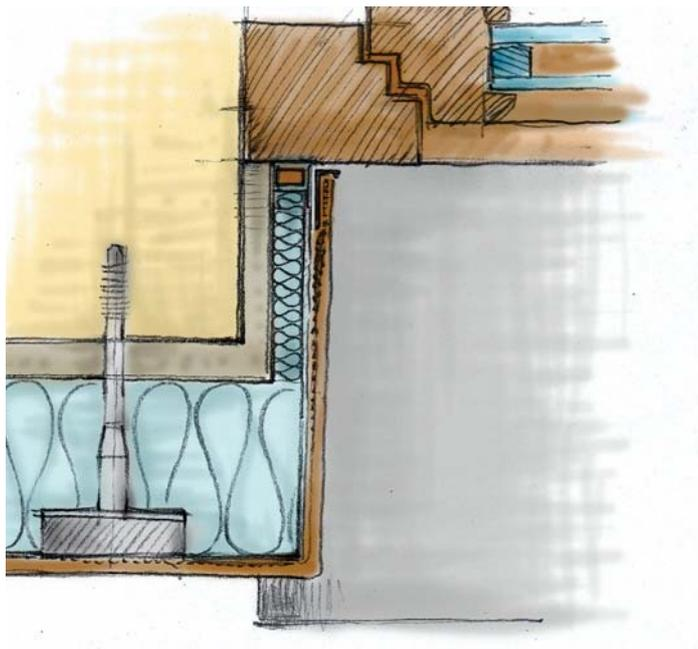
fig. 28: Disegno di pannello sulla spalletta in battuta al serramento
